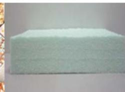
Figura 30: Aislamiento rígido de celda cerrada (Termyson)
