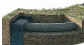
Figura 61: Protección de canalización subterránea (Huesker)
