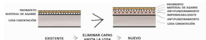
Figura 15: Impermeabilización de losa de cimentación
