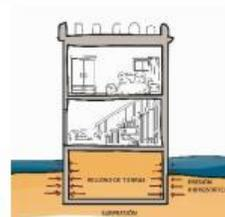
Figura 38: Relleno de espacio inferior hasta forjado superior
